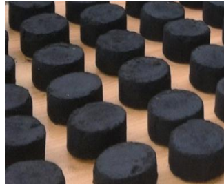
Gambar 3. Briket pellet ukuran \Phi 4 cm, Panjang 2 cm
