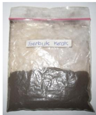
Gambar 7. Serbuk kerak dari dinding pipa
