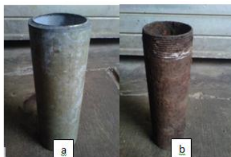
Gambar 2. Material Penelitian (a) pipa baru dan (b) pipa terkorosi
