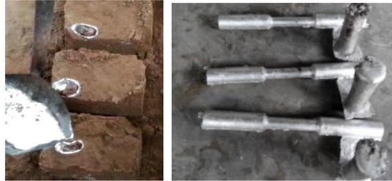
**Gambar 5.** Proses penuangan dan spesimen hasil pengecoran.
