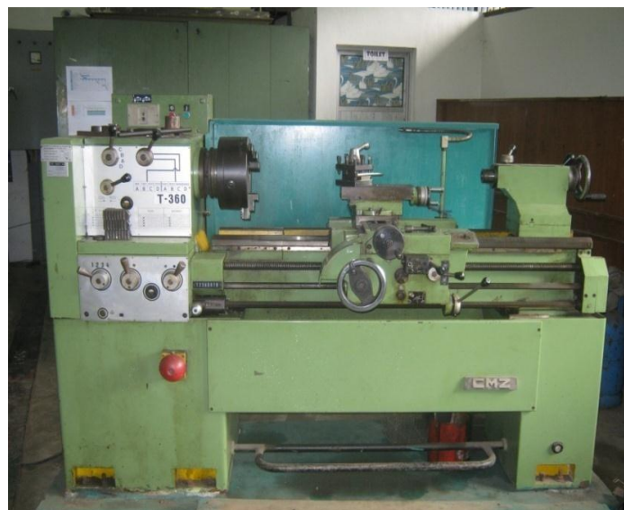
Gambar 3. Mesin bubut CMZ T360
