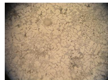
Gambar 6. Struktur Mikro Produk Sepatu Rem dengan Temperatur Penuangan 800°C
