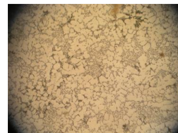
Gambar 5. Struktur Mikro Produk Sepatu Rem dengan Temperatur Penuangan 750°C
