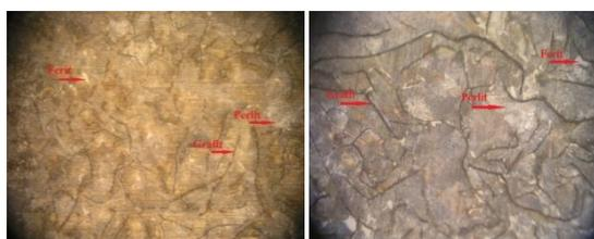
Gambar 9. Struktur mikro spesimen *base material*
