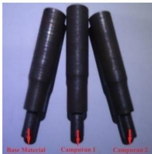
Gambar 3. Spesimen uji keausan
