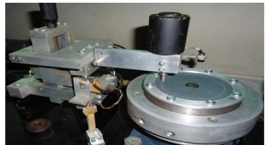
Gambar 7. Spesimen yang telah dipasang pada pemegang spesimen
