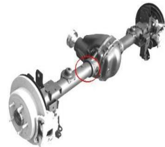
Gambar 2. Pengelasan gesek pada gardan mobil [3].
