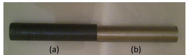
Gambar 4. Bahan uji las gesek (a) Baja ST 60 dan (b) AISI 201
