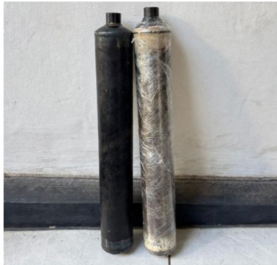
Gambar 3. Hasil Manufaktur Tangki Hidrogen Tipe I
