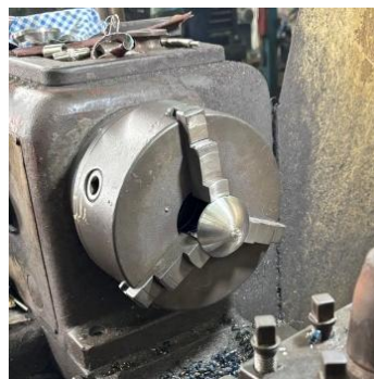
Gambar 3. Proses Pembentukan Dome Tangki Hidrogen
