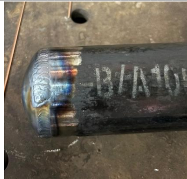
Gambar 4. Hasil Proses Pengelasan Badan Silinder dan Dome
