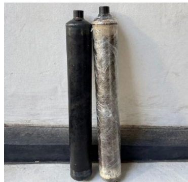
Gambar 5. Hasil Manufaktur Tangki Hidrogen Tipe I
