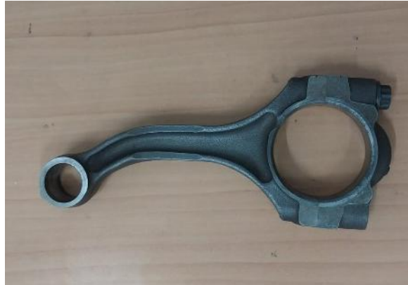
Gambar 3. Connecting Rod yang Mengalami Buckling
