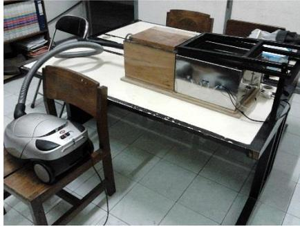
Gambar 3. Mesin Vacuum Forming yang digunakan
