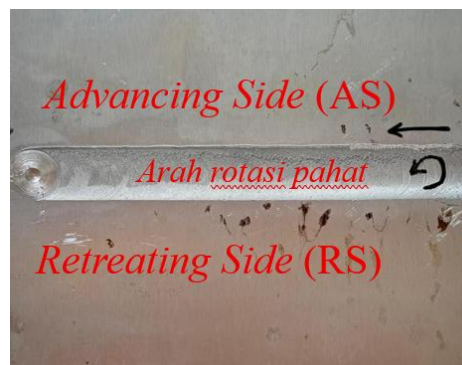
Gambar 2. Hasil pengelasan SDFS W offset 4 mm
