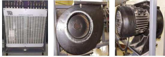
Gambar 1. Inclinable manometer dan Blower
