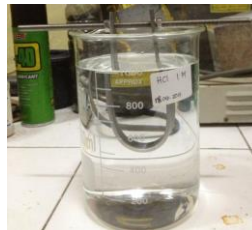
Gambar 6. Proses Perendaman Spesimen U-Bend pada Larutan Asam Klorida (HCL) 1M
