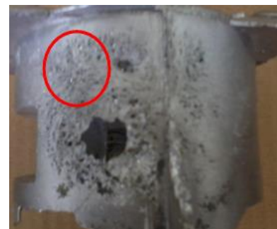
Gambar 18. Porositas pada temperatur cetakan 250°C
