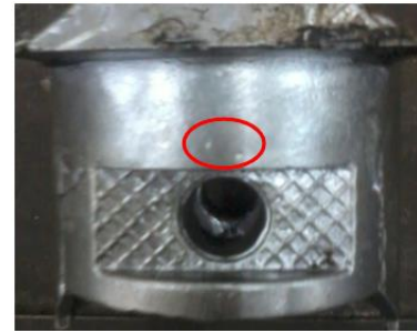
Gambar 17. Permukaan kasar pada temperatur cetakan 400°C
