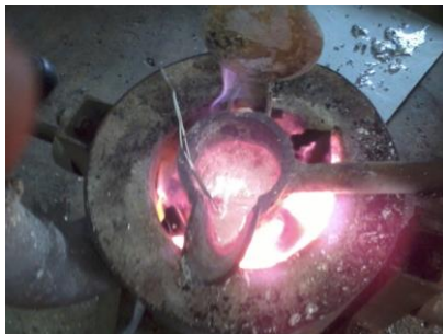
Gambar 7. Proses peleburan menggunakan tungku krusibel
