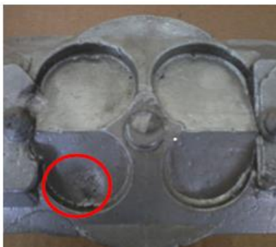
Gambar 20. Porositas pada temperatur cetakan 350°C
