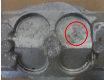
Gambar 19. Porositas pada temperatur cetakan 320°C
