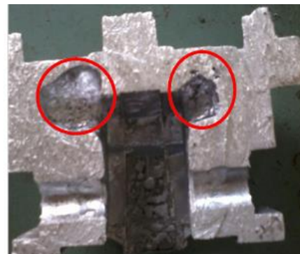
Gambar 12. Shrinkage pada temperatur cetakan 350°C
