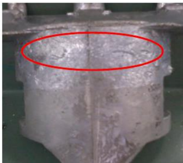
Gambar 16. Permukaan kasar pada temperatur cetakan 350°C
