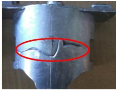
Gambar 9. Cacat pertemuan dingin pada temperatur cetakan 250°C
