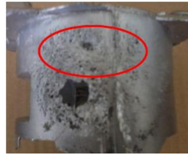
Gambar 14. Permukaan kasar pada temperatur cetakan 250°C
