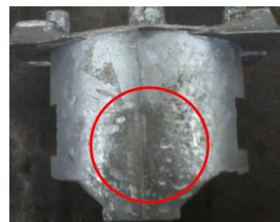
Gambar 15. Permukaan kasar pada temperatur cetakan 320°C
