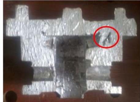
Gambar 11. Shrinkage pada temperatur cetakan 320°C
