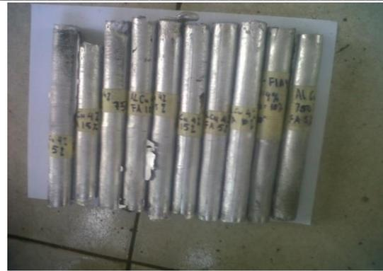
Gambar 8. Spesimen Hasil Pengecoran
