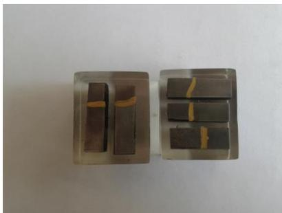
**Gambar 6.** Specimen pengujian baja UIC-54 Setelah di *mounting*.
