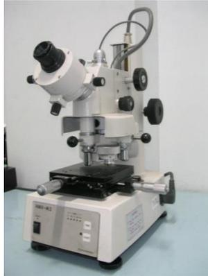
**Gambar 5.** Alat uji kekerasan vickers [15].
