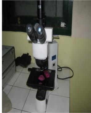
**Gambar 7.** Alat uji metalografi
