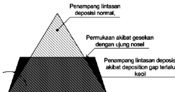
Gambar 8. Kemiringan penampang lintasan deposisi membesar akibat tergesek puncak lintasan deposisi oleh permukaan nosel. [5]
