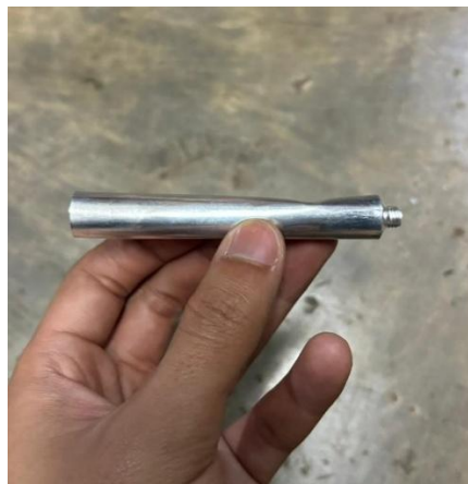
Gambar 13. Hasil Pengujian Drop Test Pada Collapsible Tube Tampak Samping
