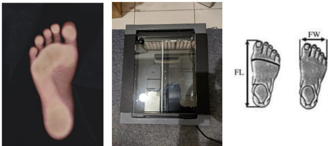
Gambar 2. Proses Pemindaian 2D telapak kaki: hasil scan telapak kaki, alat footprint scanner, parameter FL dan FW untuk menentukan ukuran sepatu
