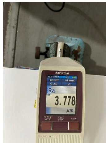
Gambar 2. Pengukuran kekasaran permukaan ( Surface Roughness Tester )
