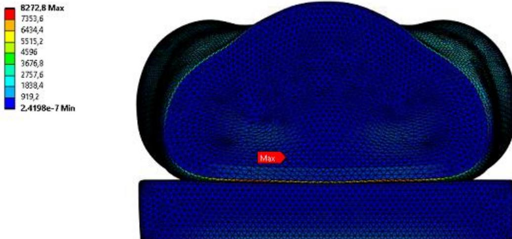
Gambar 3. Tegangan *Von Mises* Pada Tubuh dan Matras
