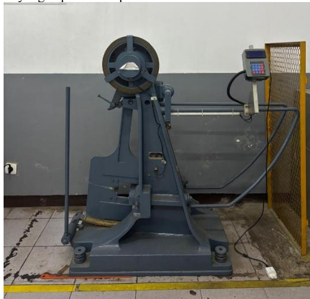
Gambar 5. Mesin Pengujian Impak di Laboratorium Material Teknik Mesin
