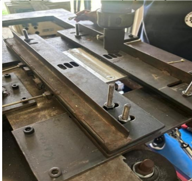
Gambar 4. Proses DS FSW selesai dilakukan
