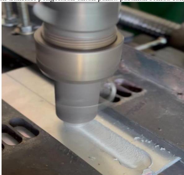
Gambar 3. Proses gerakan translasi pengelasan pada DS FSW
