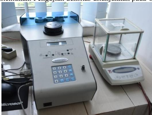
Gambar 1. Proses pengujian densitas.
