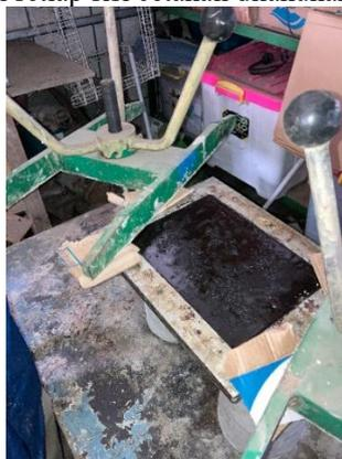
**Gambar 3.** Proses vibrasi spesimen
