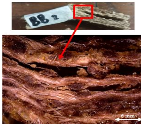
Gambar 10. Delaminasi pada spesimen setelah uji impact.
