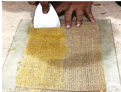
Gambar 4. Pelapisan matriks pada serat rami anyam.
