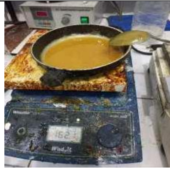
Gambar 3. Pembuatan matriks menggunakan kompor listrik.
