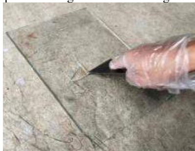
Gambar 2. Pengolesan oli/ wax pada kaca.
