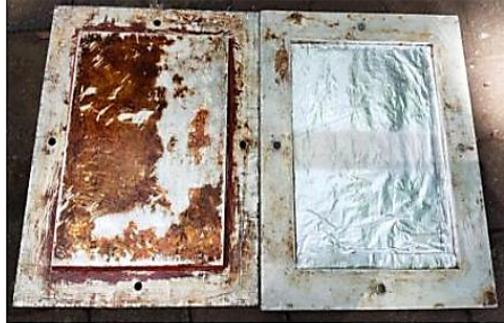
**Gambar 4.** Spesimen dilapisi menggunakan aluminium foil.
