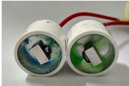
Gambar 3. Hasil Grinding dan Polishing Spesimen
