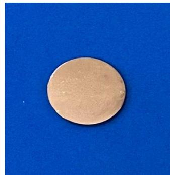
**Gambar 3.3** Spesimen setelah proses elektroplating
