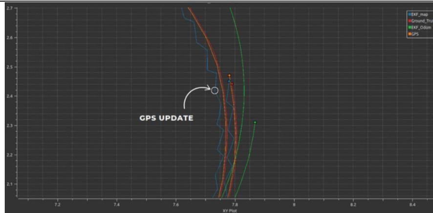
**Gambar 9** Output Extended Kalman Filter di mana GPS mengoreksi EKF ke posisi sebenarnya
