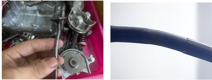
Gambar 4. Katup mengalami bengkok (bent valve)
