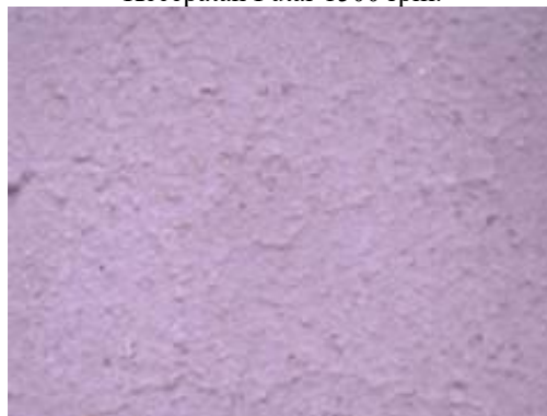
Gambar 3. Struktur Makro Subtrat Korundum Sesudah Pelapisan Titanium Dioksida pada Konsentrasi 10% dan Kecepatan Putar 1500 rpm.
