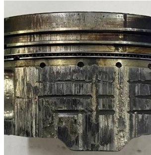
Gambar 8. Bentuk Kerusakan pada piston
