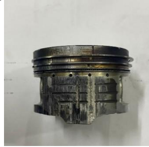
Gambar 1. Komponen Piston yang gagal
