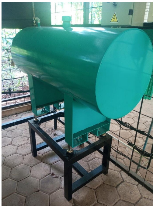
Gambar 12. Alat Pengukur Laju Konsumsi Bahan Bakar Menggunakan Load cell
