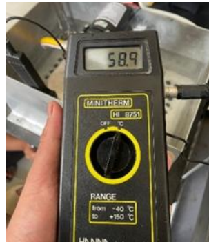
Gambar 2. Pengujian suhu air masuk dengan alat thermistor thermometer
