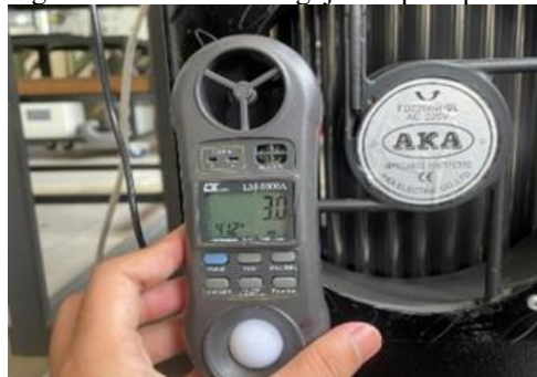
Gambar 3. Pengujian suhu udara keluar dengan alat anemometer digital display
