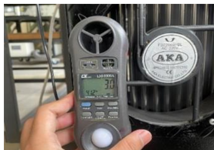
Gambar 4. Pengujian suhu udara keluar dengan alat anemometer digital display
