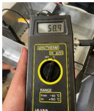
Gambar 3 Pengujian suhu air masuk dengan alat thermistor thermometer
