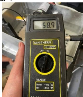
Gambar 4. Pengecekan suhu air dengan microprocessor thermistor thermometer
