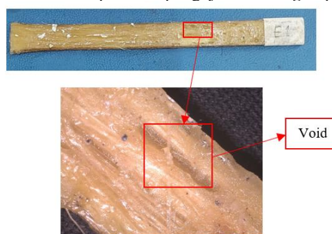
Gambar 4. Void pada Spesimen Pengujian Bending
