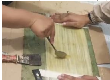
Gambar 2. Proses pelapisan matriks pada serat komposit dengan metode hand lay-up
