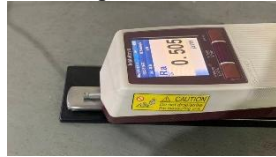
Gambar 5. Pengujian kekasaran permukaan spesimen
