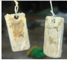
Gambar 15. lapisan coating yang tidak menempel pada spesimen
