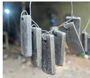
Gambar 9. Spesimen sedang dikeringkan setelah direndam zinc ammonium chloride .
