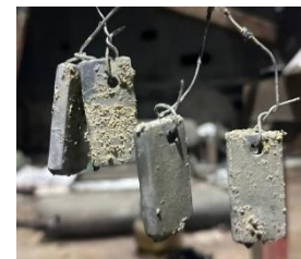
Gambar 13. Ash yang masih menempel pada hasil hot dip galvanizing
