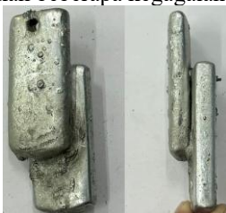
Gambar 11. Antar spesimen hasil hot dip galvanizing yang saling menempel
