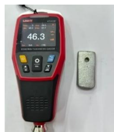
Gambar 21. Pengukuran ketebalan spesimen
