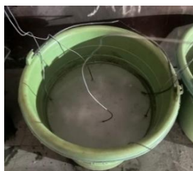
Gambar 7. spesimen sedang direndam didalam larutan HCl
