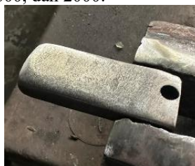
Gambar 4. spesimen yang telah dipotong, diberi lubang, dan diampelas
