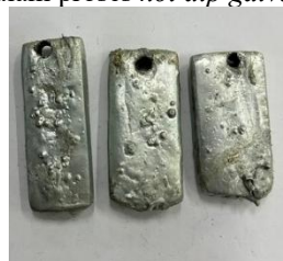
Gambar 12. Gumpalan zinc yang masih menempel pada hasil hot dip galvanizing
