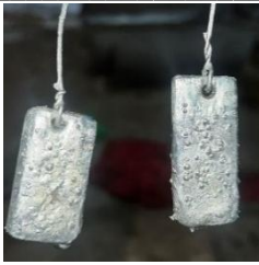
Gambar 14. Gelembung udara yang menempel pada hasil hot dip galvanizing
