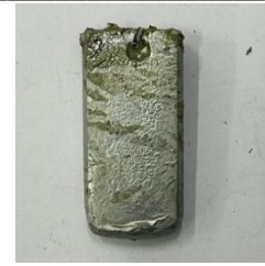
Gambar 16. Zinc yang menguning akibat zinc ammonium chloride yang larut di permukaan
