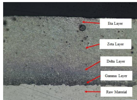
Gambar 20. Pengujian mikrografi spesimen variasi amplas grid 2000 hasil hot dip galvanizing
