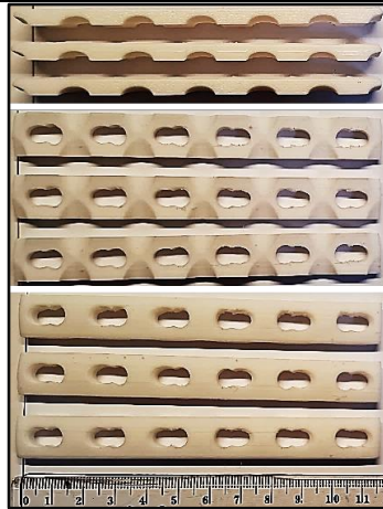
Gambar 4. LCP [90, 90]/T Sebelum Uji Tarik
