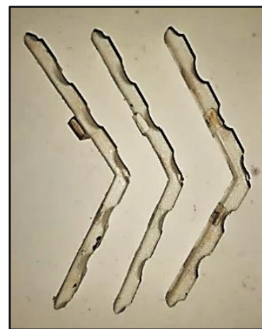
Gambar 7. LCP [90, 90]/B Sesudah Uji Tekuk
