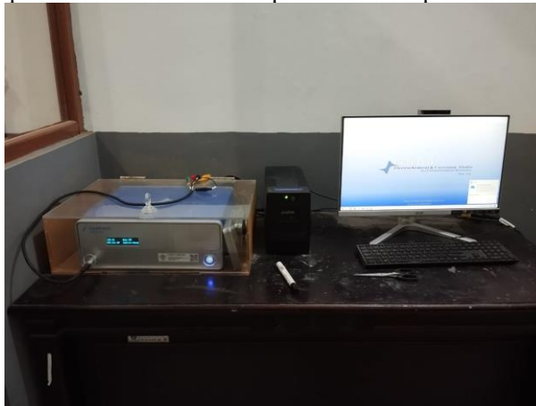
Gambar 2.8 Perangkat Alat Uji Korosi Polarisisasi Linier
