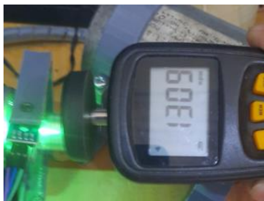
Gambar 4 Pengukuran RPM menggunakan Tachometer
