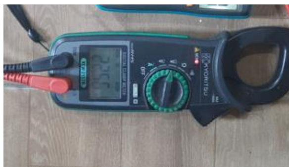
Gambar 2 Pengukuran tegangan menggunakan Avometer
