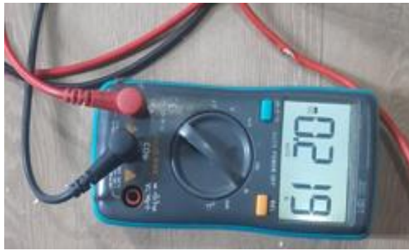
Gambar 3 Pengukuran arus menggunakan Avometer
