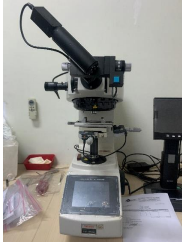
Gambar 2. Spesimen dan alat uji kekerasan Vickers
