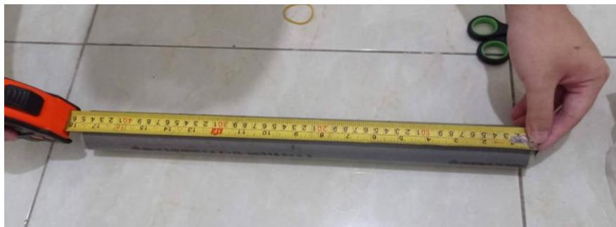
Gambar 7. Proses pengukuran dimensi *gravity roller*
