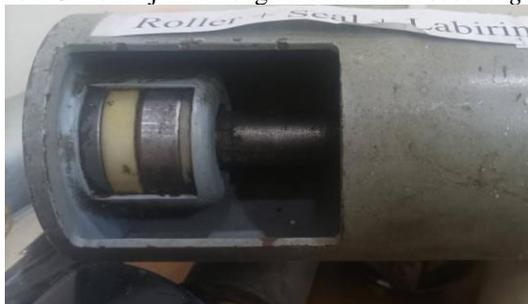
Gambar 3. Bagian dalam gravity roller
