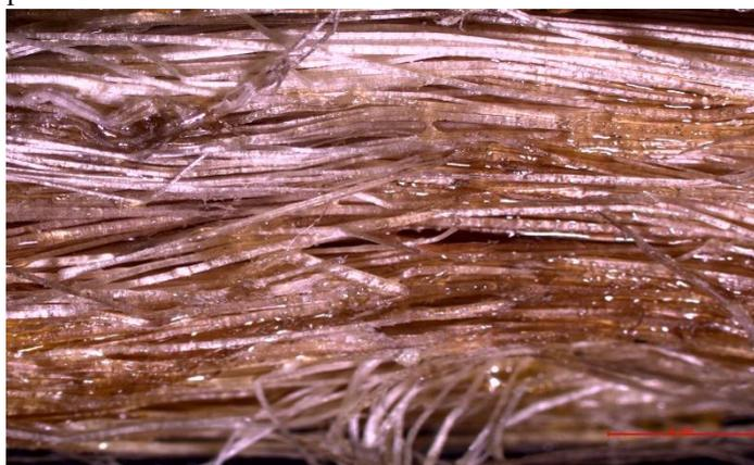
**Gambar 4.** Hasil Pengamatan Visual Patahan Spesimen
