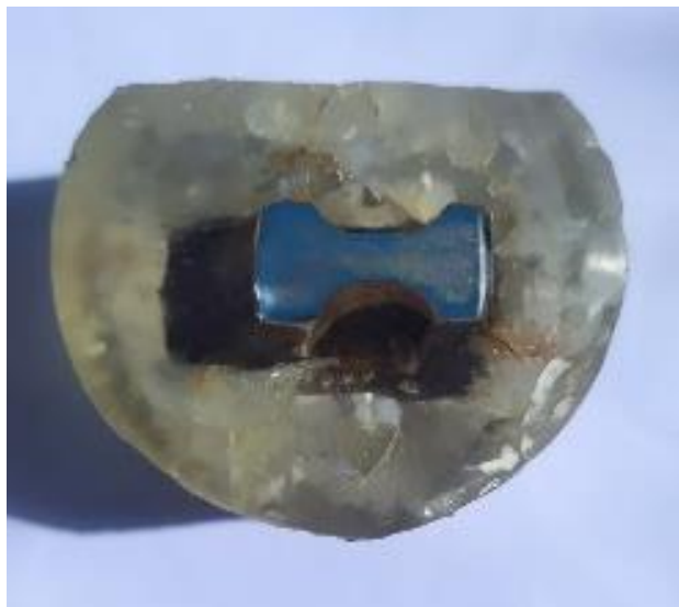
Gambar 6. Spesimen yang telah dilakukan mounting .
