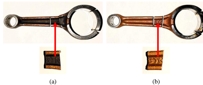
Gambar 4. Spesimen uji metalografi connecting rod (a) Gagal (b) Baru
