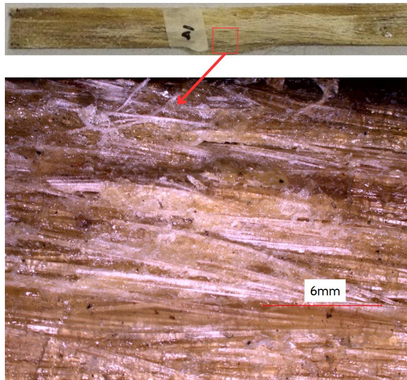
Gambar 8. Matriks pecah pada dan Jenis Kegagalan Fiber Pull-out
