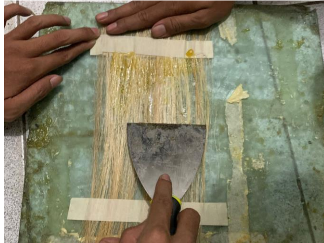
Gambar 3. Proses Pengolesan Matriks Menggunakan Metode Hand Lay-up
