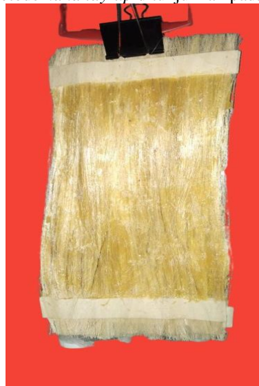
Gambar 4. Hasil Pengolesan Matriks pada Serat Rami
