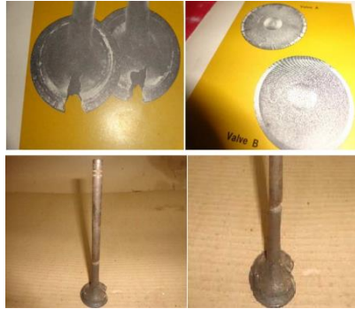
Gambar 3. Kegagalan katup karena temperatur tinggi [6]
