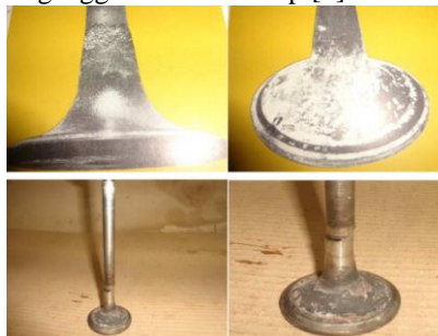
Gambar 4. Kegagalan karena korosi-erosi [6]
